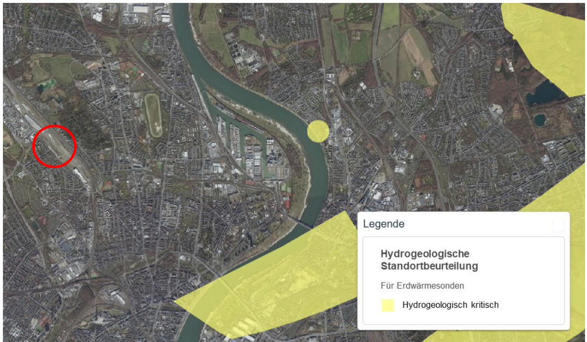
Bild 7-5: Hydrogeologische Standortbeurteilung für Erdwärmesonden
