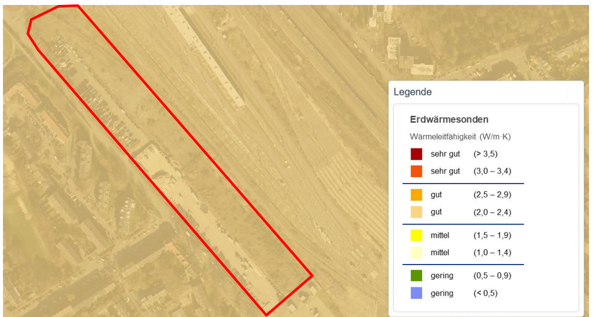
Bild 7-3: Wärmeleitfähigkeit, Sondenlänge 80 m, Untersuchungsbereich ist rot markiert
