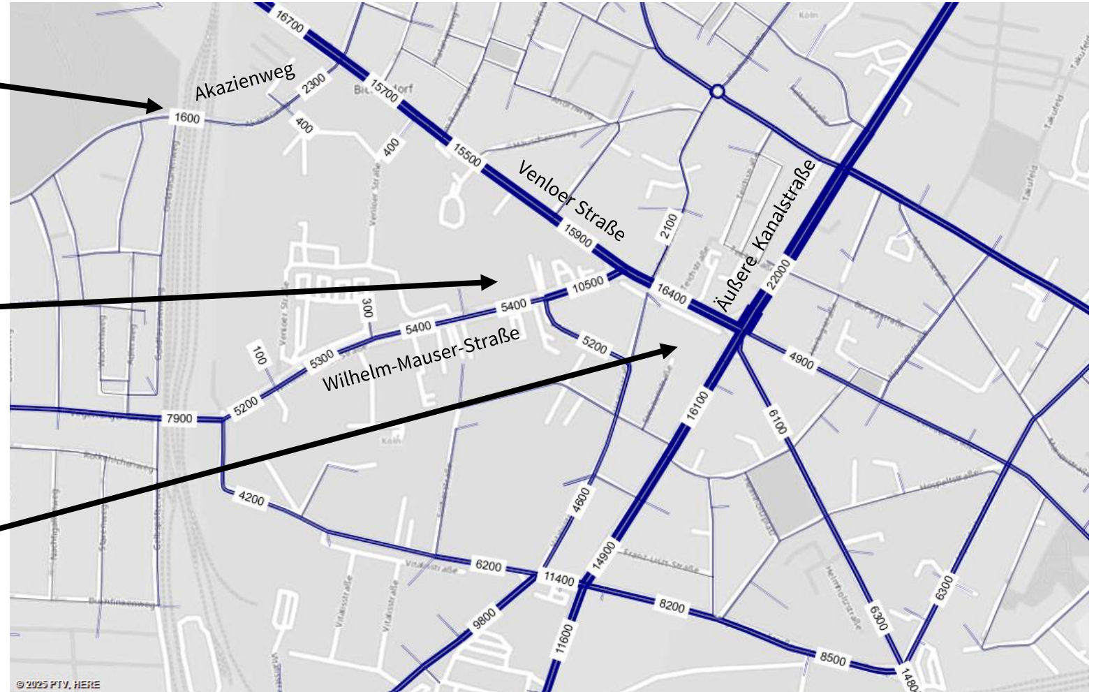
Streckenbelastung Analysefall Tagesverkehr [Kfz/24 h]
