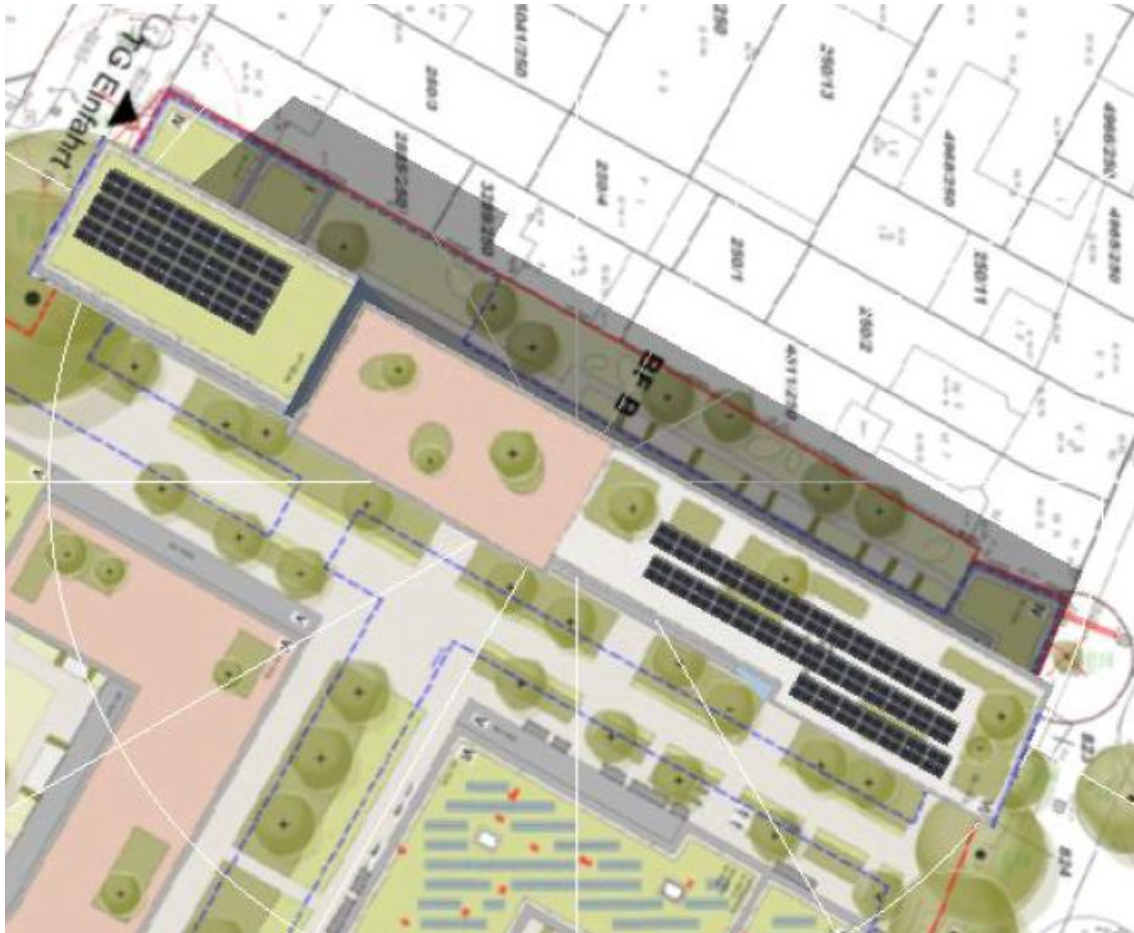
Abbildung 23: Entwurf Dachaufsichten mit konzeptioneller Darstellung möglicher PV-Anlagen BT B
