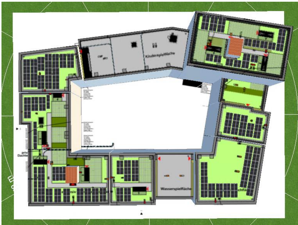
Abbildung 22: Entwurf Dachaufsichten mit konzeptioneller Darstellung möglicher PV-Anlagen BT A
