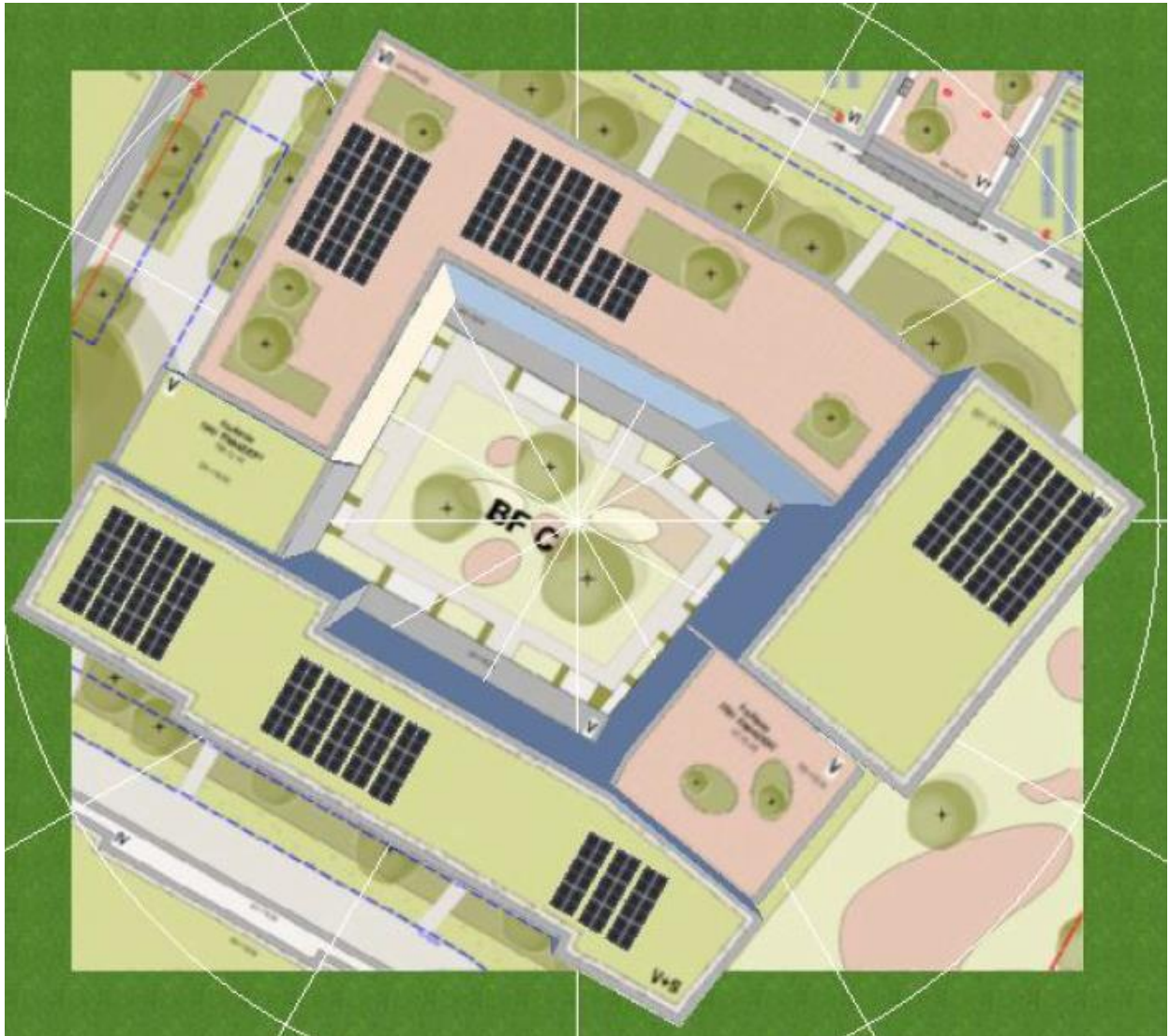
Abbildung 24: Entwurf Dachaufsichten mit konzeptioneller Darstellung möglicher PV-Anlagen BT C
