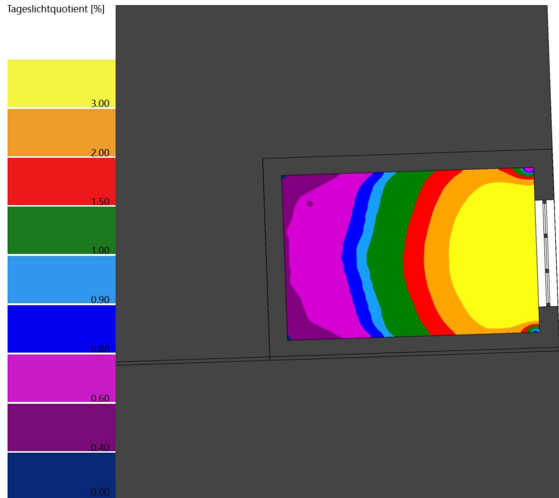
Grundrissdarstellung – Erdgeschoss Fehlfarbendarstellung des Tageslichtquotienten
